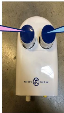
Centrale de dilution
